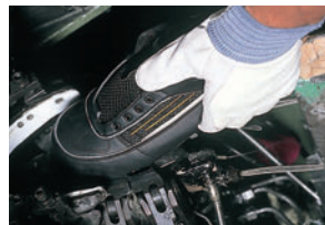
吊込工程 Lasting
