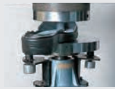
JIS規格による耐圧迫性能試験：試験方法<抜粋>
