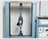
JIS規格による表底のはく離抵抗試験：試験方法<抜粋>
